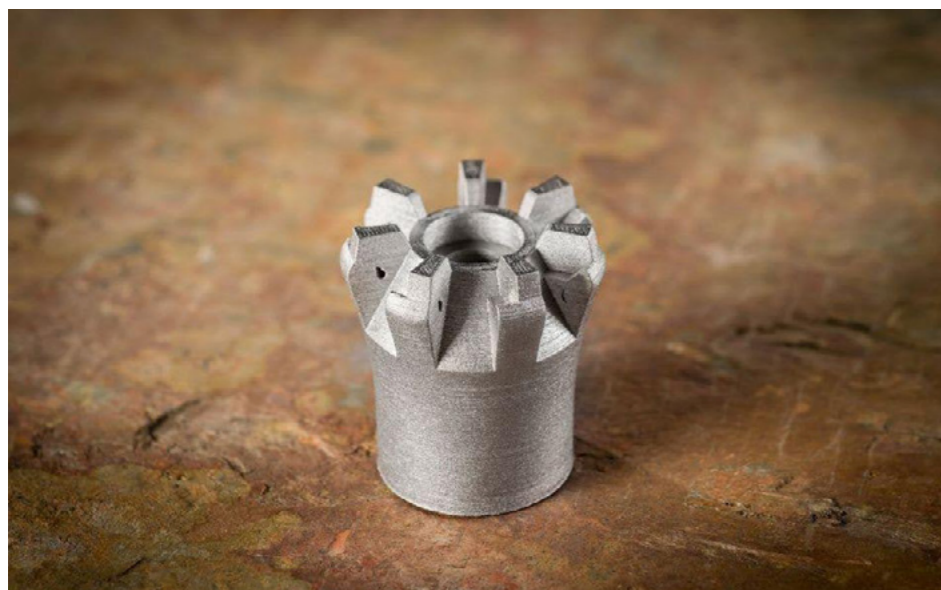
Image 6: Des pièces complexes en acier inoxydable 17-4 PH sont produites de manière efficace et économique sur une imprimante 3D FFF de bureau. Crédit image : UltiMaker.
