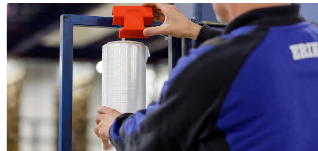
Image 7: Un outil imprimé en 3D permet aux opérateurs de remplacer rapidement et en toute sécurité un rouleau de film d'emballage. Crédit image : UltiMaker
