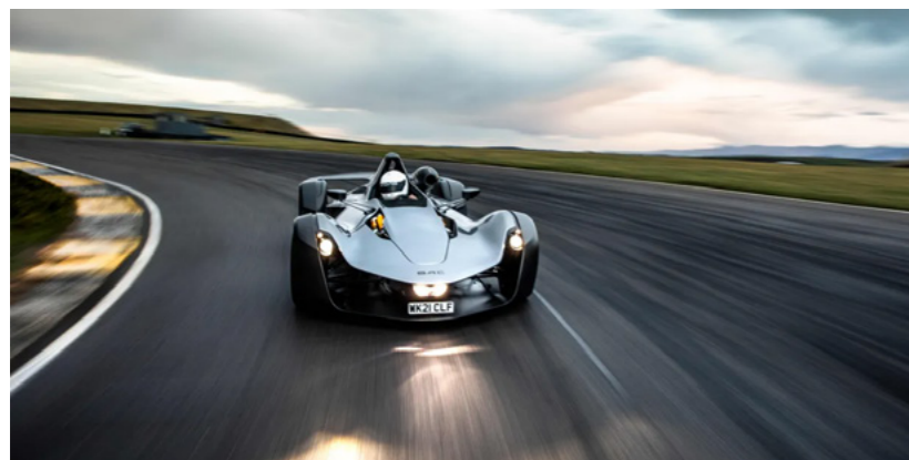
Image 17: La Mono R de BAC intègre plus de 44 pièces finales imprimées en 3D. Crédit image : UltiMaker
