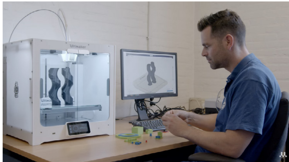
Image 12: Le spécialiste technique de Trivium, Paul Klopper, imprime en 3D une vis d'alimentation pour la ligne de production vieillissante.
