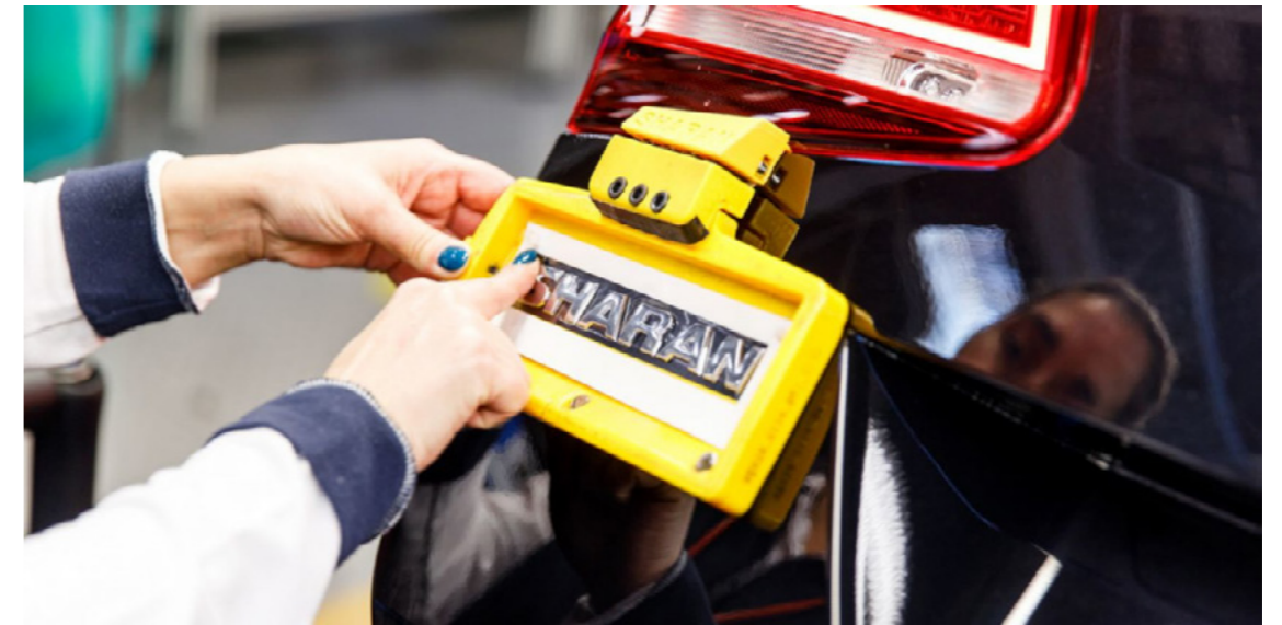
Image 16 Le badge de hayon imprimé en 3D à l'usine Volkswagen Autoeuropa coûte seulement 10 € par unité.
