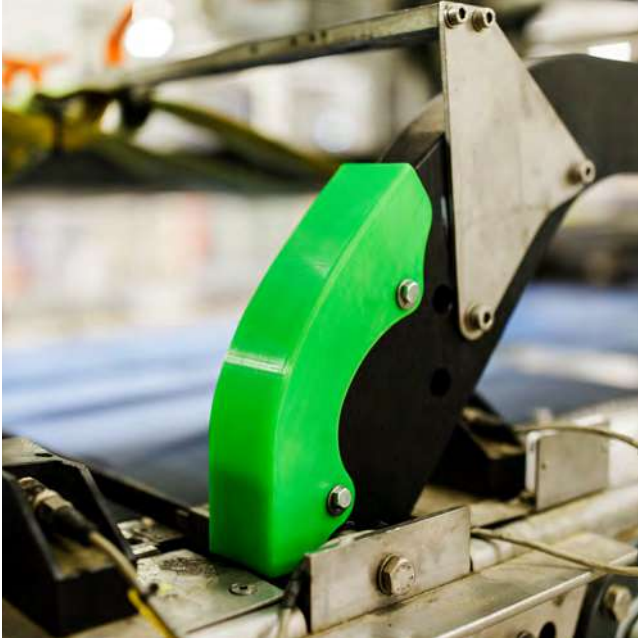
Cette simple partie réduit le risque d'accrochage des résidus ou des vêtements dans la chaîne de production
